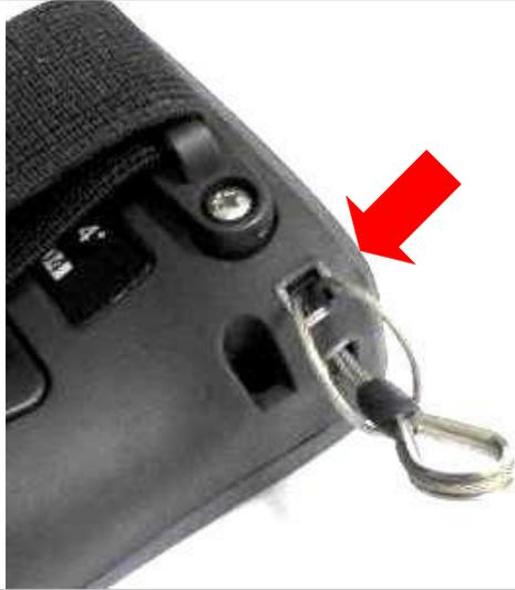
将线环安装到测厚仪本体上，只需将线环穿过仪表上的孔，然后连到另一端。
